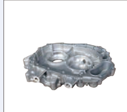
零件：变速箱体 材料：铸铝ALSi9Cu3 加工内容：孔面精铣 加工精度：6级
