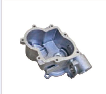
零件：机壳体 材料：铸铝 加工内容：孔面精铣 加工精度：6级
