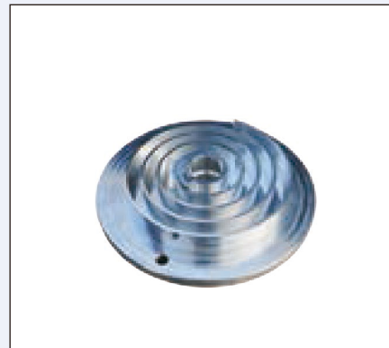
零件：蜗旋盘 材料：铸铁/铸铝 加工内容：螺旋面精铣 加工精度：轮廓度<0.015mm
