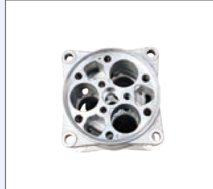
零件：压缩机缸体 材料：铸铝R14 加工内容：孔面精铣 加工精度：6级
