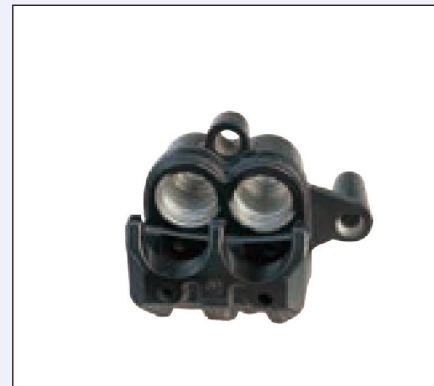
零件：卡钳 材料：铸铁/铸铝 加工内容：孔铣钻 加工精度：6级
